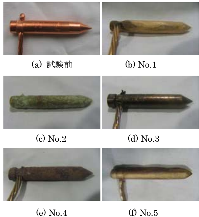
図 3. 試験前後の各試験電極の銅覆鋼棒の概観
